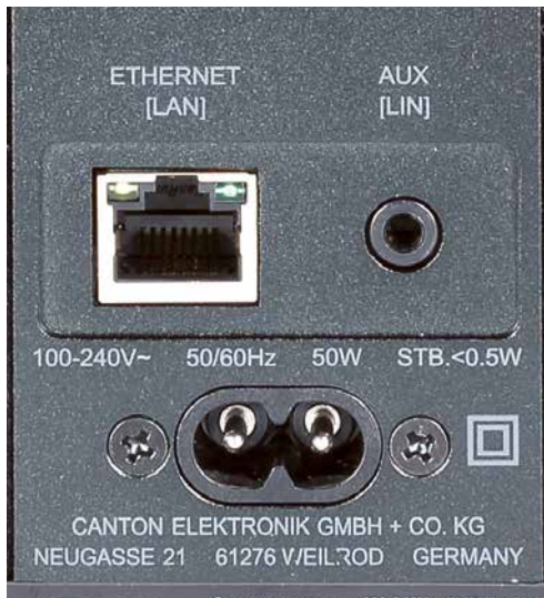
LAN- und Analogeingang sowie der Netzanschluss finden sich auf der Rückseite.
