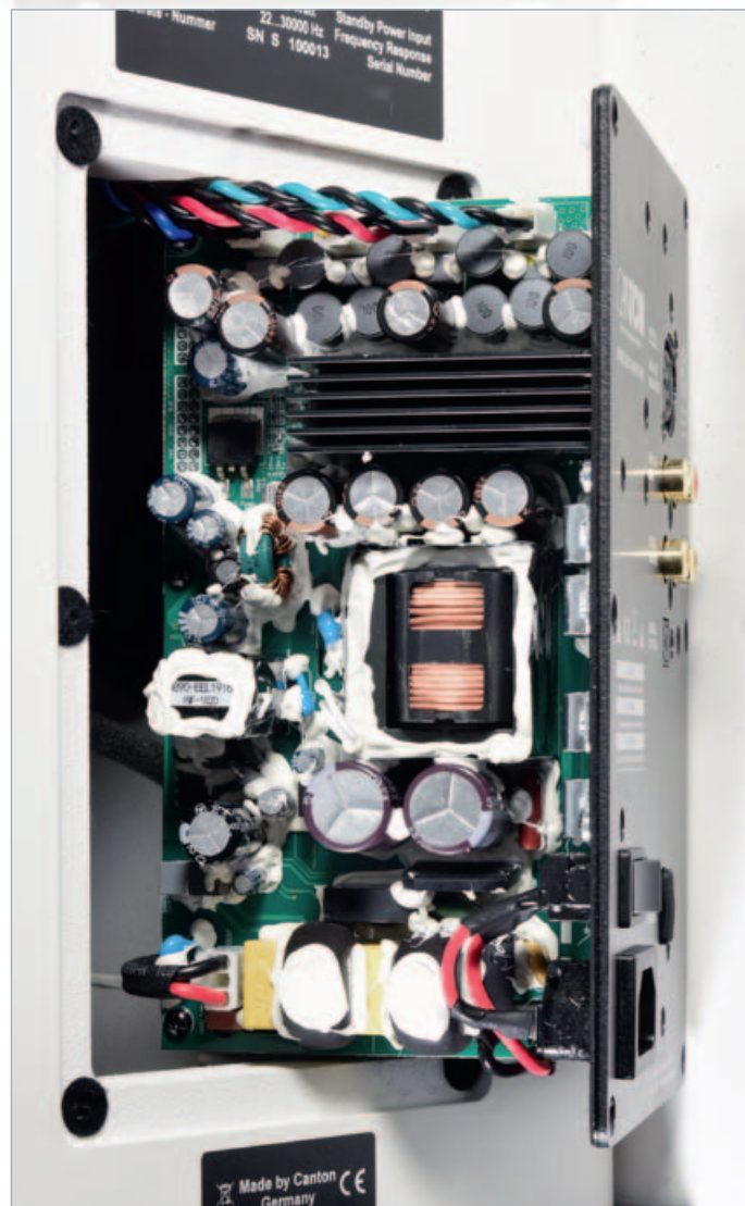
Die Kraft- und Signalzentrale: Canton vertraut einem Digitalverstärker, der 600 Watt an Musikleistung aufzubringen vermag. Das ist stattlich. Der zentrale Chip stammt von Texas Instruments.
