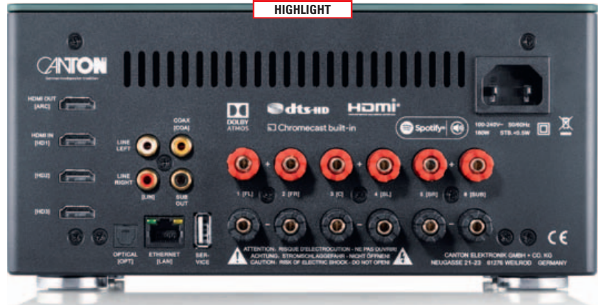
ÜBERSICHTLICH: Während auf der Rückseite von AV-Receiver oft geradezu eine Armada von Steckern auf den Anwender wartet, bietet der Canton Smart Amp 5.1 ein übersichtliches Anschlussfeld. Für die meisten Szenarien dürfte das genügen.
