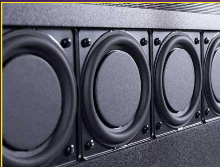
Diese 4 Tieftöner finden wir auf der Unterseite, sie haben je 100 mm im Durchmesser. Dank der Bassreflex-Bauweise kommt das Sounddeck damit bis hinunter auf 25 Hz
