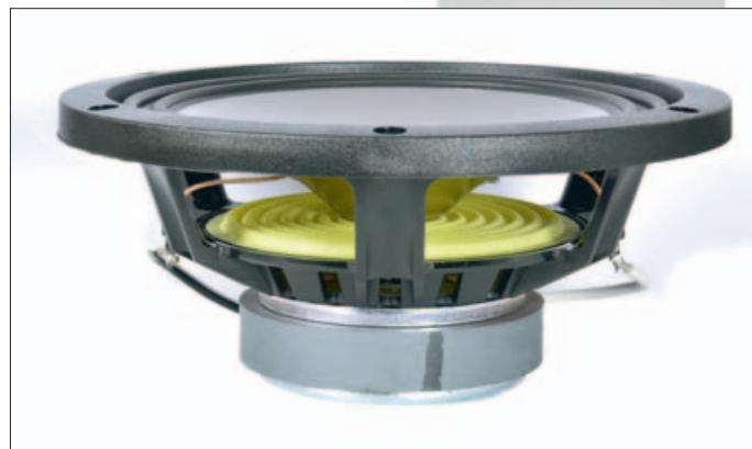
Der Tieftöner muss größere Hübe leisten, folglich hat er auch den stabileren Korb mit sechs statt vier Streben.
