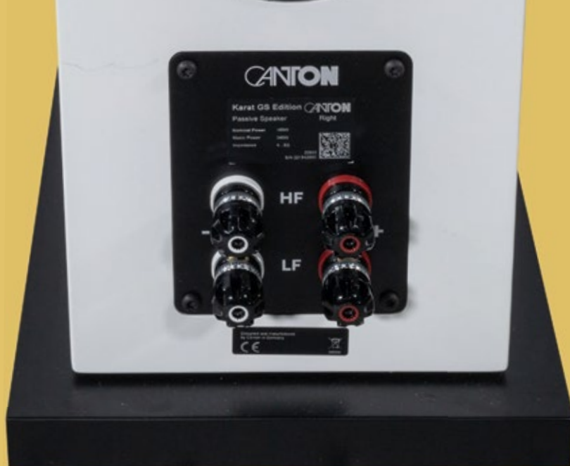
Canton offeriert bei der Neuauflage der Karat sowohl Bi-Amping als auch Bi-Wiring. Die Anschlüsse sind dabei von gewohnt hervorragender Qualität
